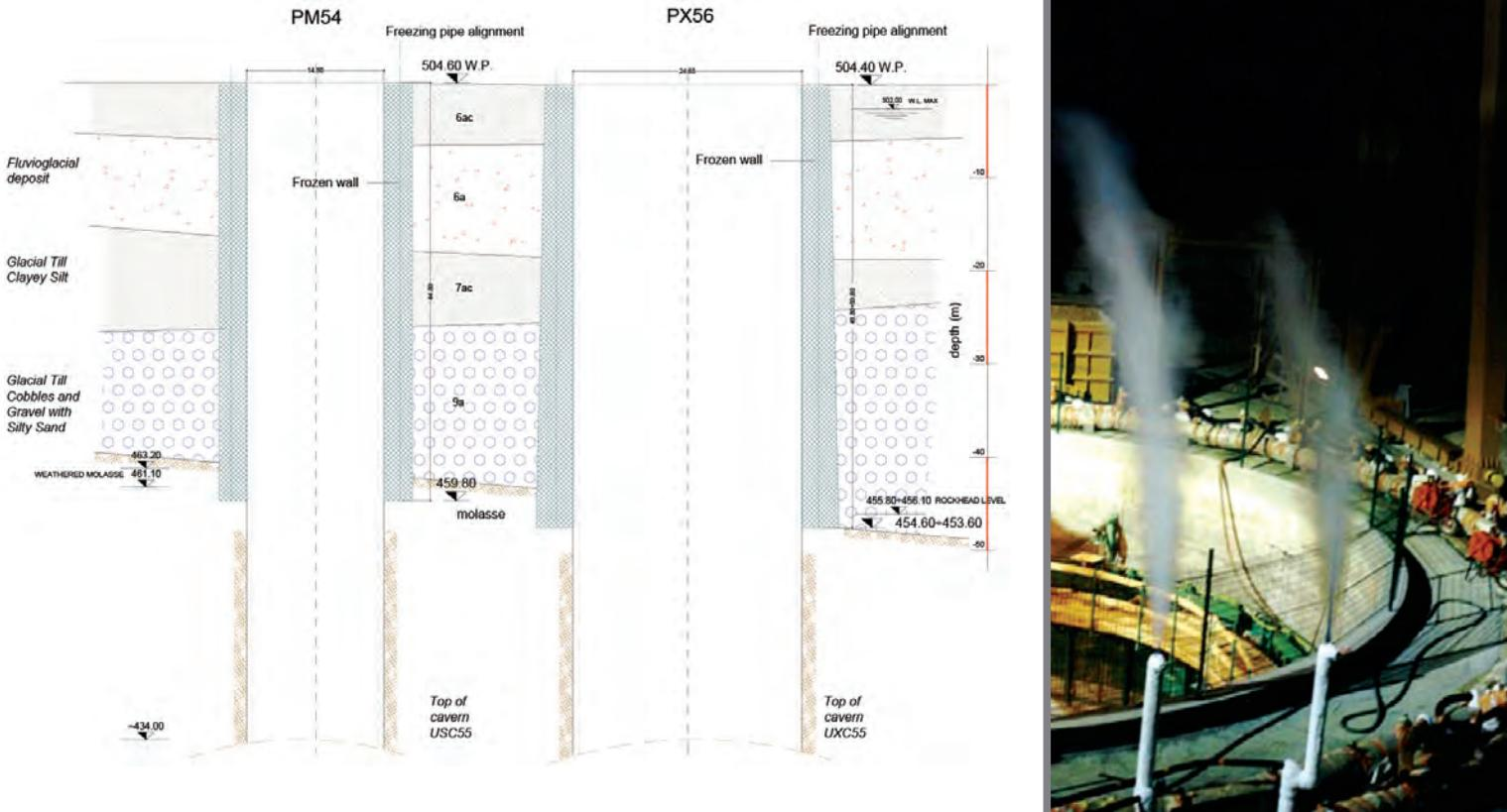
muro di terreno congelato quale supporto temporaneo e sistema di impermeabilizzazione per consentire lo scavo dei pozzi e la costruzione dei rivestimenti interni.
